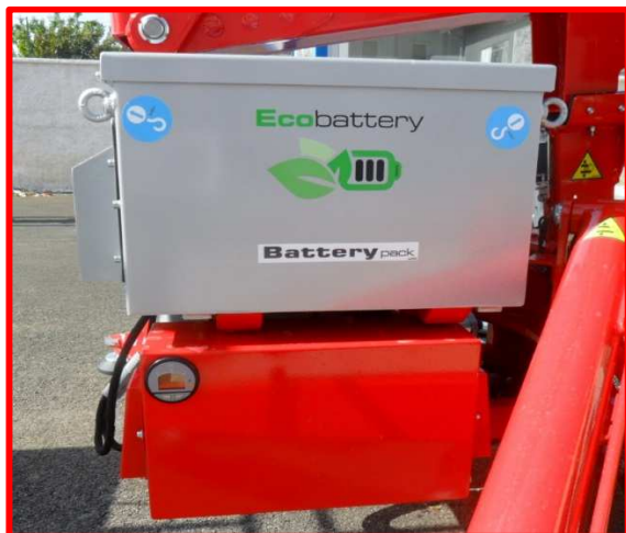
Figure 17 : bloc batteries au lithium.
