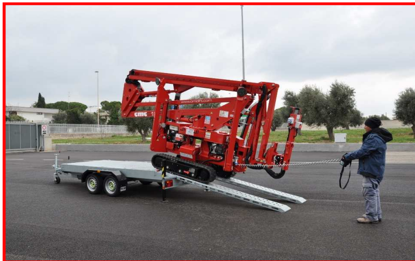
Figure 13 : chargement / déchargement à l'aide d'une rampe.
